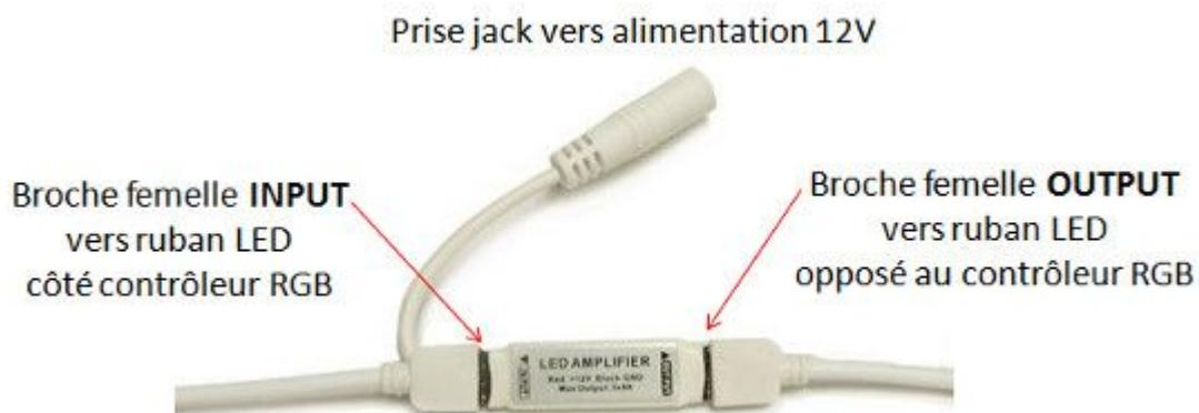
pour que cet amplificateur fonctionne, il a besoin d'une alimentation électrique. La puissance de l'alimentation électrique dépend de la longueur de ruban que l'amplificateur devra supporter. **Voir la FAQ** pour des explications supplémentaires.
